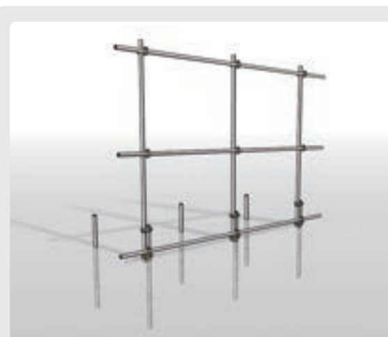
3 横に流す布パイプを取り付けます
