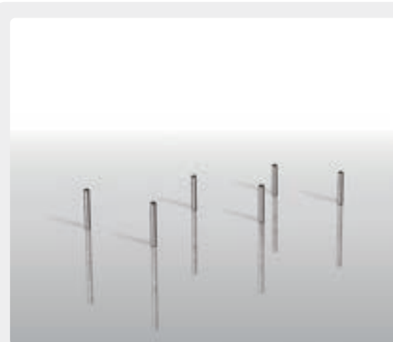
1 杭パイプを地中に打ち込みます
