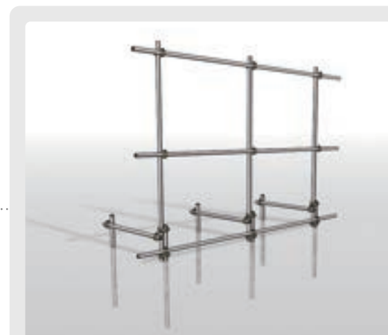
4 水平につなぎパイプを取り付けます
