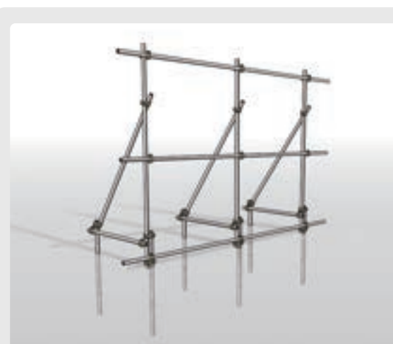
5 斜めに控えパイプを取り付けます
